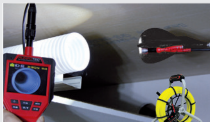
Kontrola a servis vzduchotechniky
